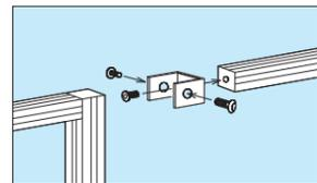
フレームの連結は専用の連結金具を採用している為、位置決めがしっかりでき、組み立ても容易にできます。
