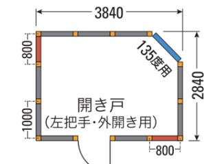
※設置の際は必ず床面にアンカー固定して下さい。
