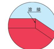
棚板のコーナーは全て溶接の為、皿型使用によりドレン受けとしても利用できます。(フラット型にも変更可能)
