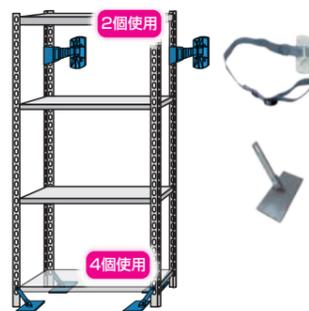
床や壁に接着し固定を行う方法。簡易で後付け可能。
